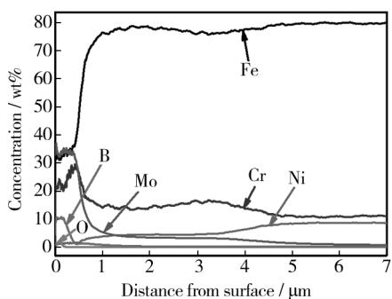
图2 渗硼处理后渗层中成分分布曲线
