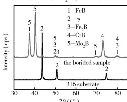
图3 基体和渗硼层的X射线衍射图
