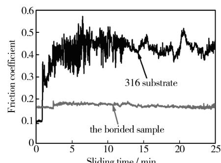
图4 基体和渗硼试样摩擦系数随滑动时间的变化
