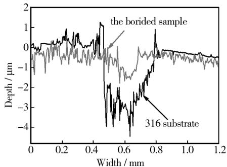
图6 基体与渗硼试样的表面磨痕轮廓
