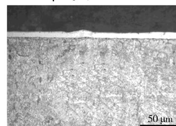
图 1 AISI316 不锈钢渗硼处理后截面的金相组织
