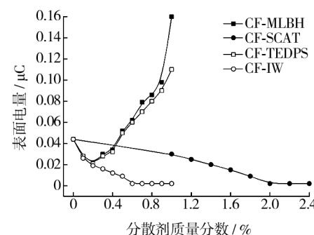
图3 分散剂类型对碳纤维表面电量的影响
