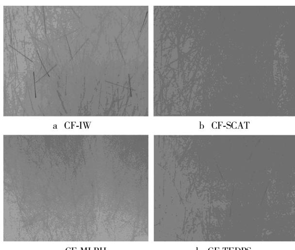
图2 在最佳分散剂浓度下浸丝的碳纤维分散效果
