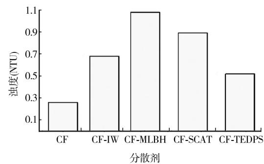
图4 分散剂类型对分散体系浊度值的影响
