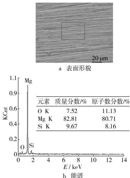
图 1 Mg-S 表面形貌及 EDS 能谱
