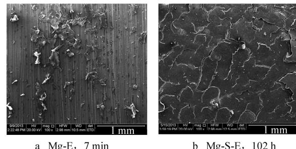
图7 试样 NMP 实验后的表面 SEM 形貌
