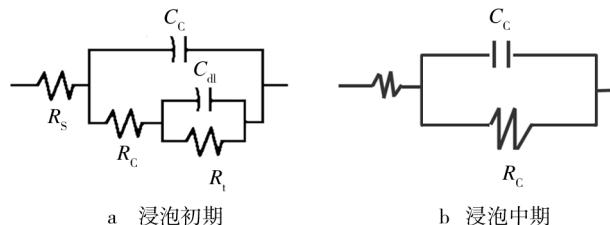
图5 不同浸泡时期的模拟等效电路
