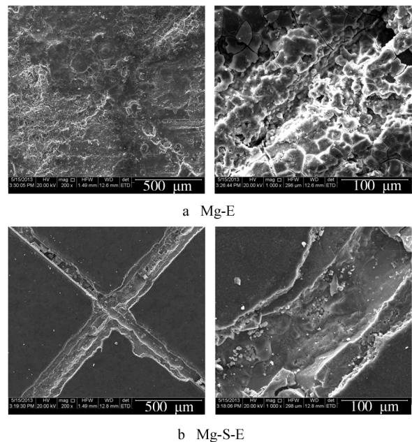
图6 试样 Machu 实验后划痕交叉处的 SEM 形貌
