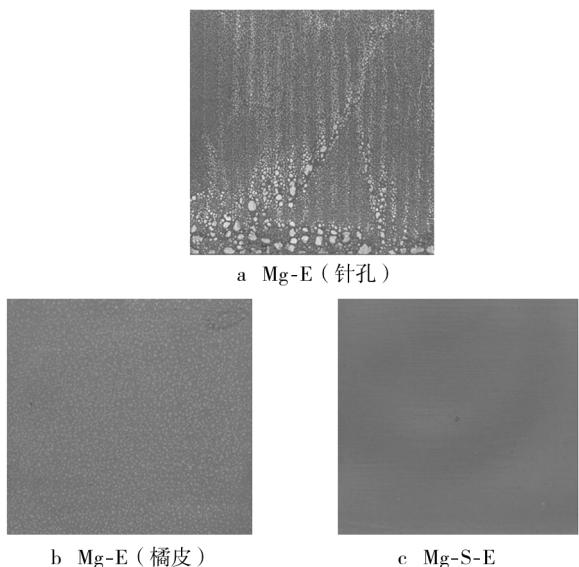
图 3 阴极电泳试样的表面形貌
