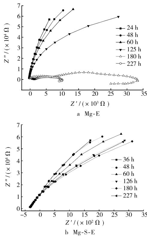
图4 试样浸泡不同时间的阻抗谱图
