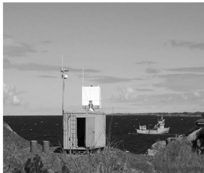
图 5 挪威海军舰船 RCS 的动态测量
