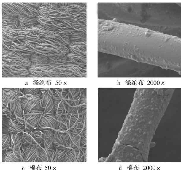
图 1 织物化学镀镍后的扫描电镜形貌
