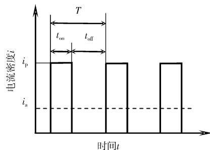
图1 矩形波脉冲电流波形示意图
