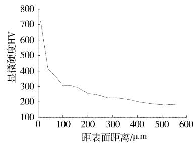
图3 试样截面的显微硬度分布
