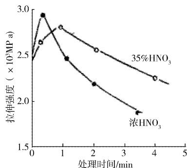
图 2 硝酸处理碳纤维对其拉伸强度的影响<sup>[16]</sup>
