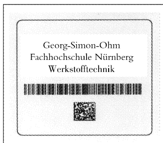
图3 激光刻写的标签记号
